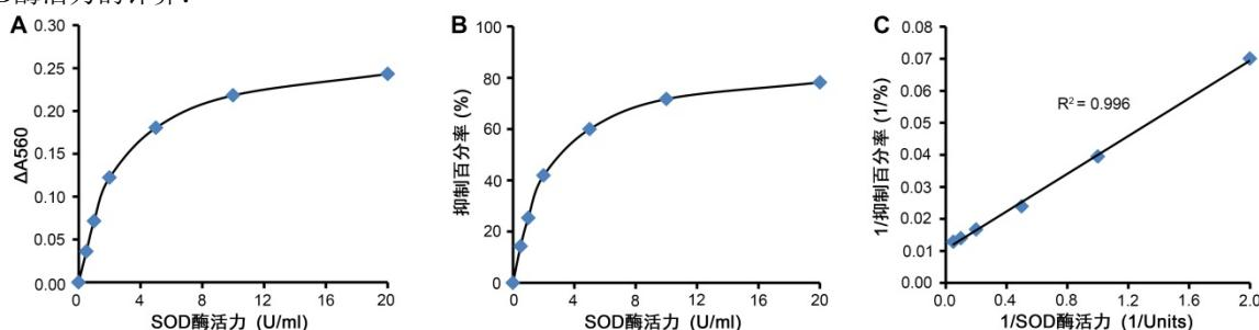
图2. 本试剂盒对SOD标准品的检测效果。图A纵坐标 $\Delta A_{560}$ 为孵育30分钟后，空白对照与SOD标准品孔的吸光度差值。SOD酶活力和 $\Delta A_{560}$ (图A)及抑制百分率(图B)呈非线性关系，而 $1/\text{SOD酶活力}$ 和 $1/\text{抑制百分率}$ 成线性关系(图C)。图中数据仅作参考，实际测定获得的标准曲线的斜率和截距可能会因具体反应条件的不同和上图有较明显的差别。
